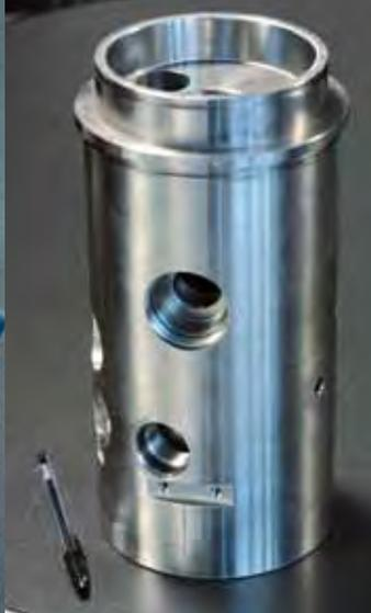
caso di una flangia con fori laterali e frontali non c'è bisogno di applicare alcuna attrezzatura speciale. L'alternativa? Prima il tornio, poi un centro di lavoro, poi l'attrezzatura per eseguire i fori laterali, magari con l'aggiunta di fori inclinati: con Integrex quattro fasi si riducono a una sola, portata a termine con un solo operatore”.
